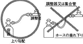
△ 高圧ホースは、再液化ガス及びドレン等が溜まるのを防ぐため、垂れ下がりをつけないよう適切な長さのものを選定し、LPガス容器から上り勾配になるように取り付けして下さい。
