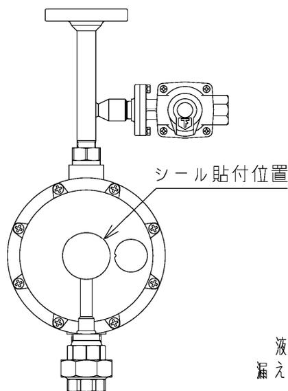
流量検知式切替型漏えい検知装置
